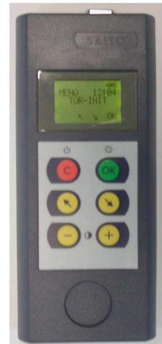
Das Programmiergerät wird am gleichen Kabel wie die Kodierstation angeschlossen (COM-Schnittstelle). Die Verbindung zwischen PC und dem Programmiergerät wird mit dem Menü-Punkt **Verbinden mit PPD** gestartet. Der Datentransfer vom Programmiergerät zur Leseinheit einer Offline-Komponenten erfolgt mit dem speziellen Verbindungskabel. Das Programmiergerät kann nur mit Offline-Komponenten des zugehörigen Systems kommunizieren.
